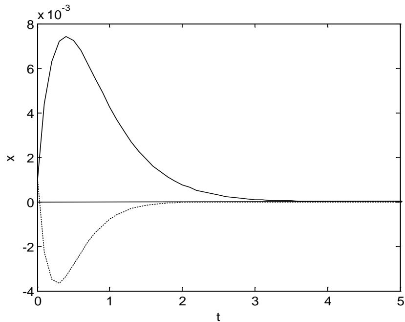
2). Να βρεθεί ο συντελεστής απόσβεσης  $c$  ώστε η απόσβεση του συστήματος να είναι κρίσιμη. Δίνονται  $m = 20 \text{ kg}$ ,  $k_1 = 10^5 \text{ N/m}$ ,  $k_2 = 2 \times 10^5 \text{ N/m}$ .
