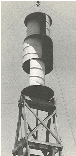
Σχήμα 6.4 Ανεμομηχανές κατακόρυφου άξονα που βασίζονται στην αεροδυναμική αντίσταση. Αριστερά αυτοσχέδια μηχανή και δεξιά συνδυασμός αντίστασης και άνωσης με κατακόρυφα πτερύγια. Η μηχανή αυτή ξεκινάει μόνη της από νηνεμία. Στο παρακάτω σχήμα 6.5 φαίνεται το εσωτερικό μιας σύγχρονης ανεμογεννήτριας.
