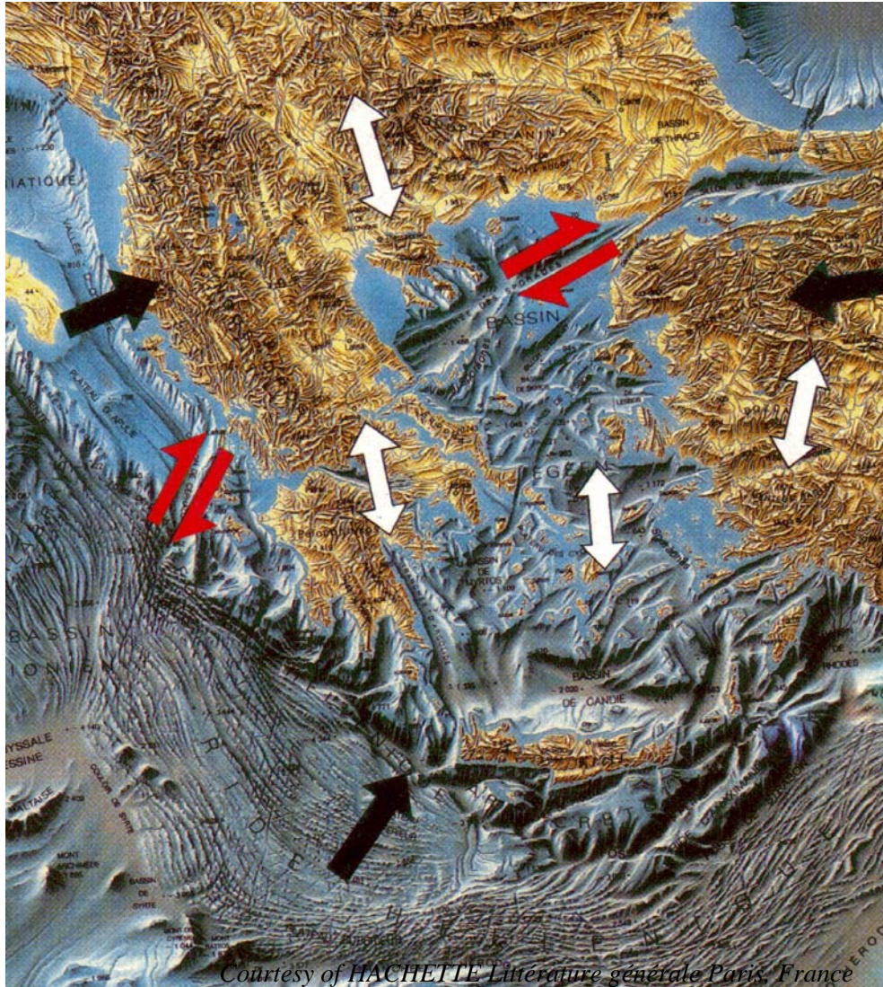
Εικόνα 8-6 Γεωδυναμικό μοντέλο Ελληνικού χώρου. Μαύρα βέλη: κίνηση των λιθοσφαιρικών πλακών, λευκά βέλη: αναπτυσσόμενες τάσεις, κόκκινα βέλη: διεύθυνση ολίσθησης τεμαχών ρηγμάτων.
