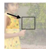
Μακρομπλόκ με υπέρθεση στη θέση καλύτερου ταυρίσματος που δείχνει το διάνυσμα κίνησης
