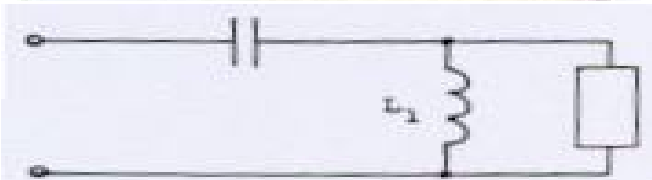
Σχήμα 12: Ένα υψηλοπερατό πρωτότυπο κύκλωμα προσαρμογής σύνθετης αντίστασης χρησιμοποιώντας διακριτά στοιχεία.
