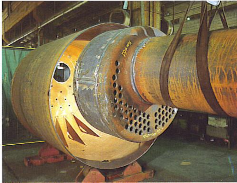
Σχήμα 5.3 βιομηχανικός αεριαυλωτός ατμολέβητας στη φάση της κατασκευής - μοντάρισμα θαλάμου καύσης με το εξωτερικό κυλινδρικό σώμα-
