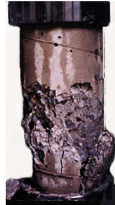
Διαμήκειες ρωγμές σε δοκίμιο χάλυβα σε διεύθυνση 45^{\circ} (διάτμηση)
