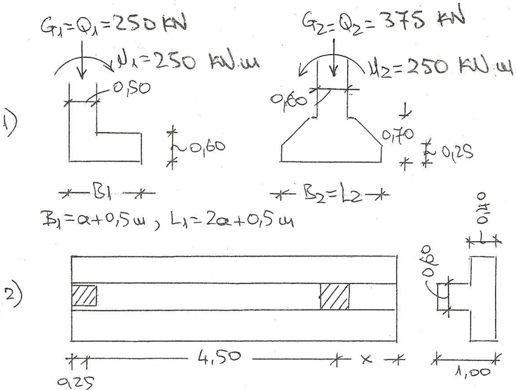
1. Θα θεμελιωθούν σε έδαφος με επιτρ. τάση  $120 \text{ KN} / \text{m}^2$ . Για τον πρώτο στύλο να γίνει ορθογωνικό, επίπεδο πέδιλο (με ίδιο προβολάκι  $a$  και στις 2 κατευθύνσεις),  $h = 60 \text{ cm}$  και υλικά **C20 – S500**. Έλεγχοι σε κάμψη, διάτμηση και διάτρηση. (4,5 μονάδες)
