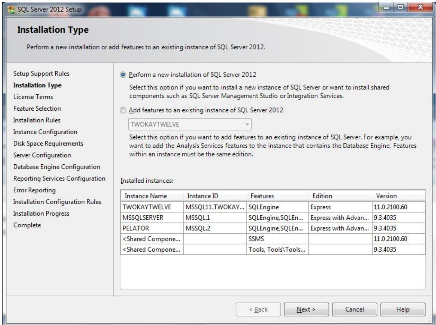
Εδώ μπορούμε να δούμε τις εγκαταστάσεις που έχουμε ήδη κάνει στη λίστα "Installed instances" και μπορούμε να προσθέσουμε μια καινούρια με το πρώτο check "Perform a new installation of SQL server 2012". Πατάμε επόμενο. Τσεκάρουμε Accept στο EULA και επόμενο.
